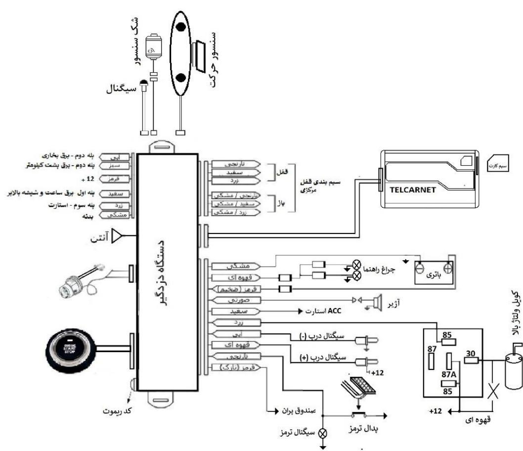
برای روشن کردن خودرو ، درب خودرو توسط ریموت باز شود تا سیستم استارت فعال شود . بعد از آن با قرار دادن پا روی پدال ترمز و فشودن کلید کیلس ، روشن می شود و برای خاموش کردن همین روای طی شود .
